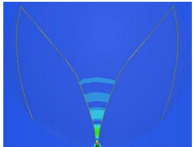
Рис. 3.12. Распределение поля в E -плоскости для ka = 14.3
