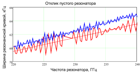
Рисунок 5 – Собственная частотная характеристика пустого резонатора: красный (внизу) – до модернизации, синий (вверху) – после модернизации (-46% СКО).
