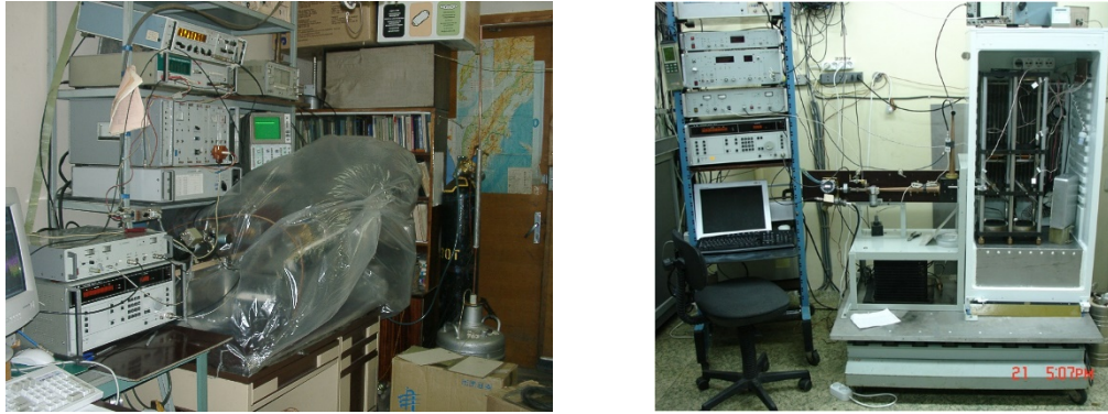
Рисунок 1.2 – Резонаторный спектрометр с измерительным элементом в холодильном шкафу и в полиэтиленовой ёмкости [69].
