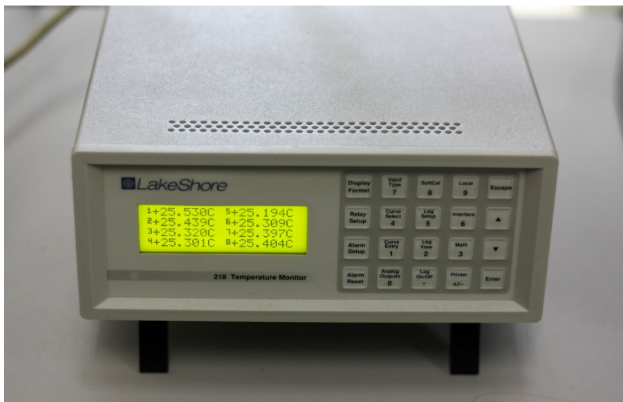
Рисунок 3.15 – Система термометрии на базе монитора LakeShore.
