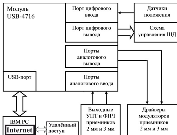
Рисунок 2.4 - Функциональная схема системы автоматизации [79]
