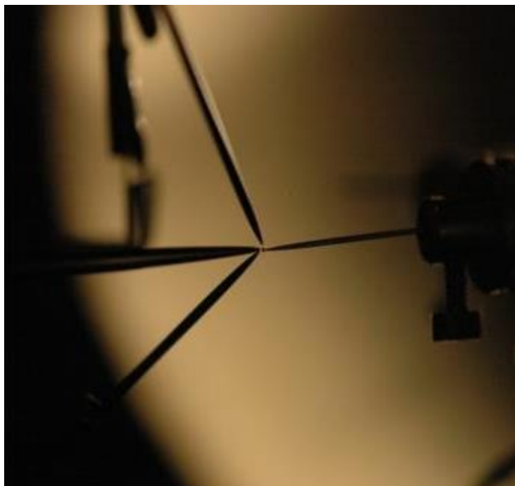
Рис. 2.4 Фотография эмиттера, закрепленного на стальной игле (справа) и конструкция электродов в сверхвысоковакуумной камере.
