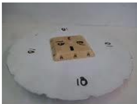
Рис. 31. Экспериментальный макет пэтч-антенны с полупрозрачным экраном с распределением изотропного резистивного импеданса.
