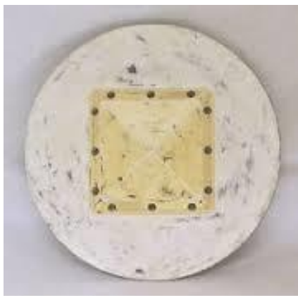
Рис. 27. Экспериментальный макет пэтч-антенны с металлическим экраном.
