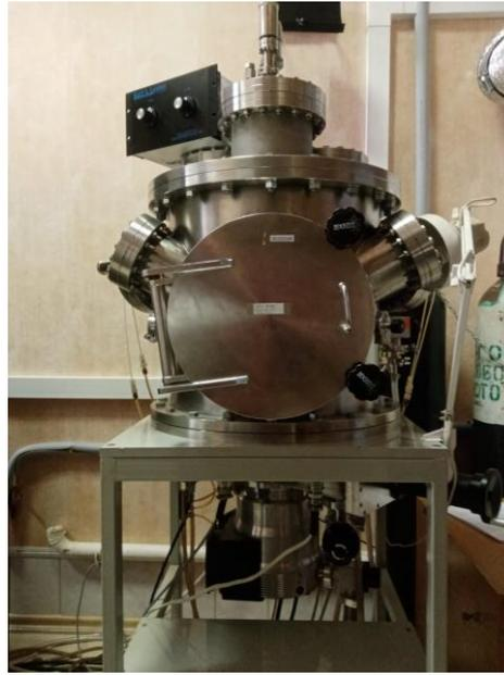
Рисунок 10. Фотография установки магнетронного распыления.
