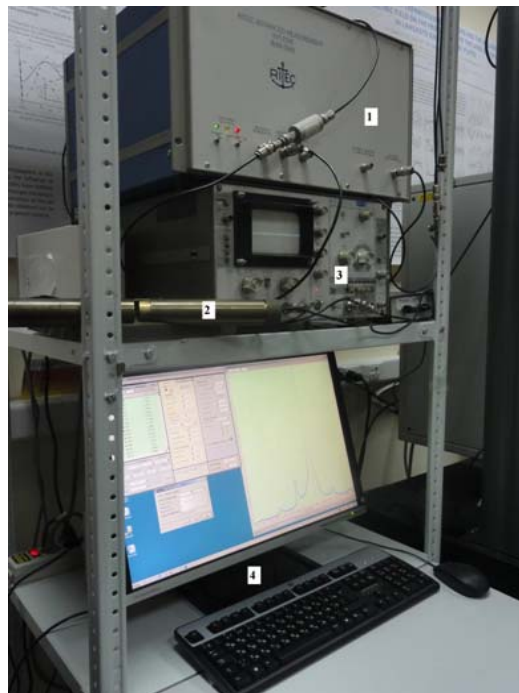
Рис. 3.2. Ультразвуковая установка для исследований скоростей звука в твёрдых телах на частотах 10-200 МГц: 1 – Ritec Advanced System RAM-5000; 2 – ультразвуковая линия; 3 – осциллограф С1-75; 4 – дисплей управляющего компьютера
